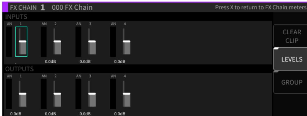
カーソルキーで変更したい入力または出力のフェーダーを選択し、ジョグホイールでハイライトされているフェーダーのシグナルレベルフェーダーを調整します。レベル画面では、[GROUP]ソフトキーでレベルフェーダーをグループ化することができます。このソフトキーの点灯時は、どちらかのフェーダーを調整すると両方のフェーダーのレベルが同様に変更されます。
