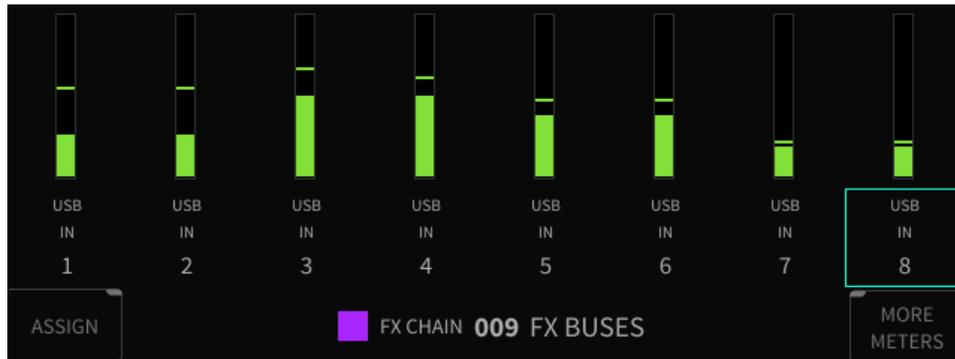
カラーディスプレイの上側には、メーターに関する情報を常時表示する 3 セグメントの 8 チャンネルの LED メーターが搭載されています。
